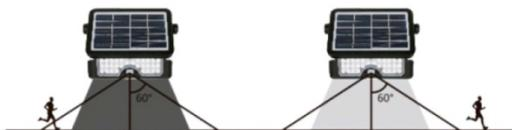
Cuando la capacidad de la batería es superior al 30% se enciende automáticamente a brillo total cuando se detecta movimiento en el rango  $\leq 6$  metros, luego se atenúa a brillo débil en 20 segundos sin movimiento.
