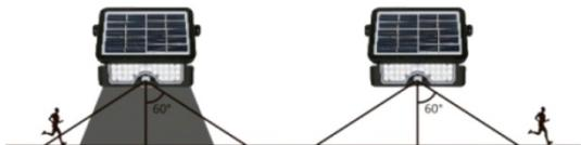
Cuando la capacidad de la batería es inferior al 30% se enciende automáticamente a pleno brillo cuando se detecta movimiento en el rango  $\leq 6$  metros, luego se apaga en 20 segundos sin movimiento.
