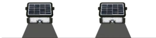
Presiona el botón durante 3 segundos y se ilumina una vez, la lámpara cambia al modo de iluminación constante, los sensores de movimiento y de luz están desactivados. Permanece permanentemente encendido hasta que la capacidad de la batería se reduzca a cero, volviendo al modo sensor.
